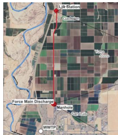
Emisor a presión entre la estación de bombeo y la PTAR
